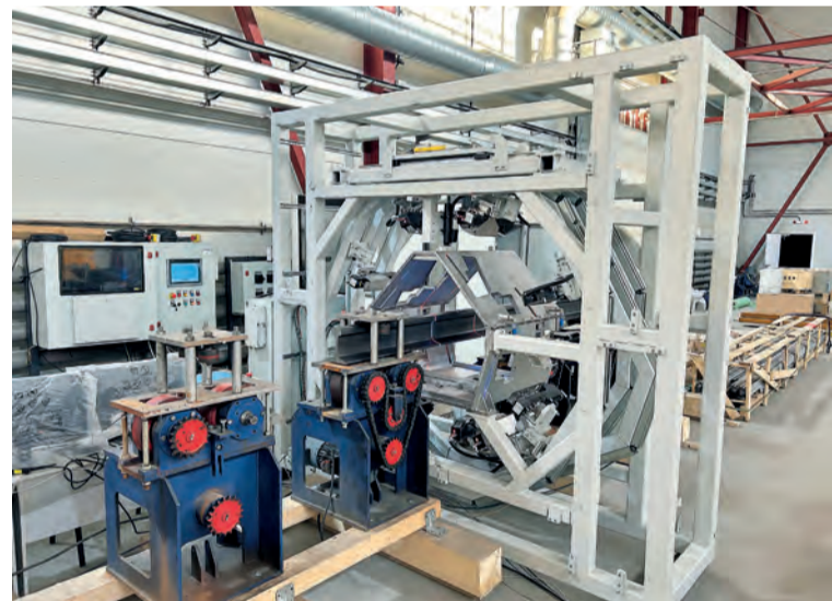
Установка измерения геометрических параметров и поверхностных дефектов рельс на рельсобалочном стане при температуре до 1100 градусов Цельсия
